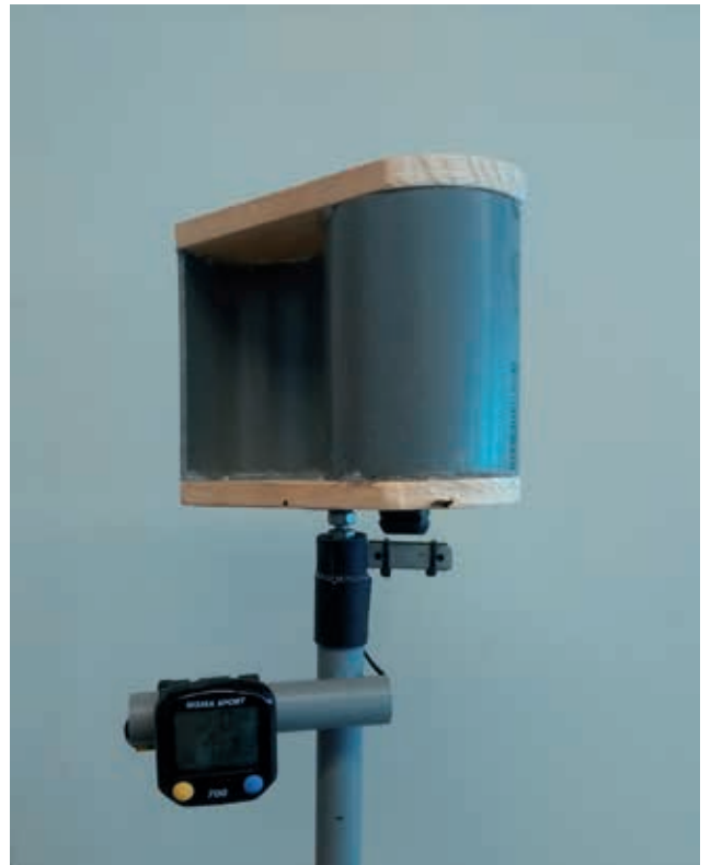
Een zelfgemaakte en geijkte windsnelheidsmeter
